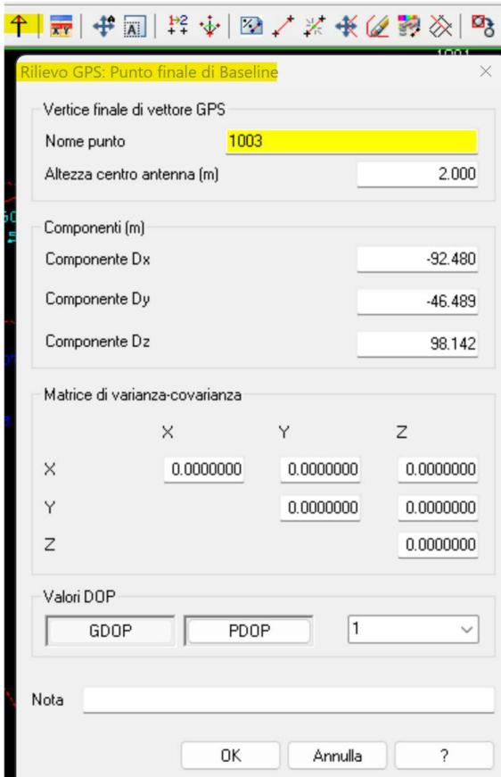
Dove è possibile trovare l'altezza dell'antenna e le componenti Dx, Dy e Dz rispetto alla base e in più, se è stata rilevata, viene riportata la matrice di varianza e covarianza del punto rilevato che dà la precisione di rilevamento in base ai satelliti osservati.
