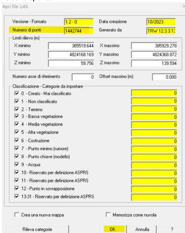
Inserendo il numero dell'asse di riferimento e un offset massimo, il software dà la possibilità di aprire solamente una parte del rilievo che si trova nel range indicato, in caso non si inseriscano tali dati verranno caricati tutti i punti presenti nel file.
