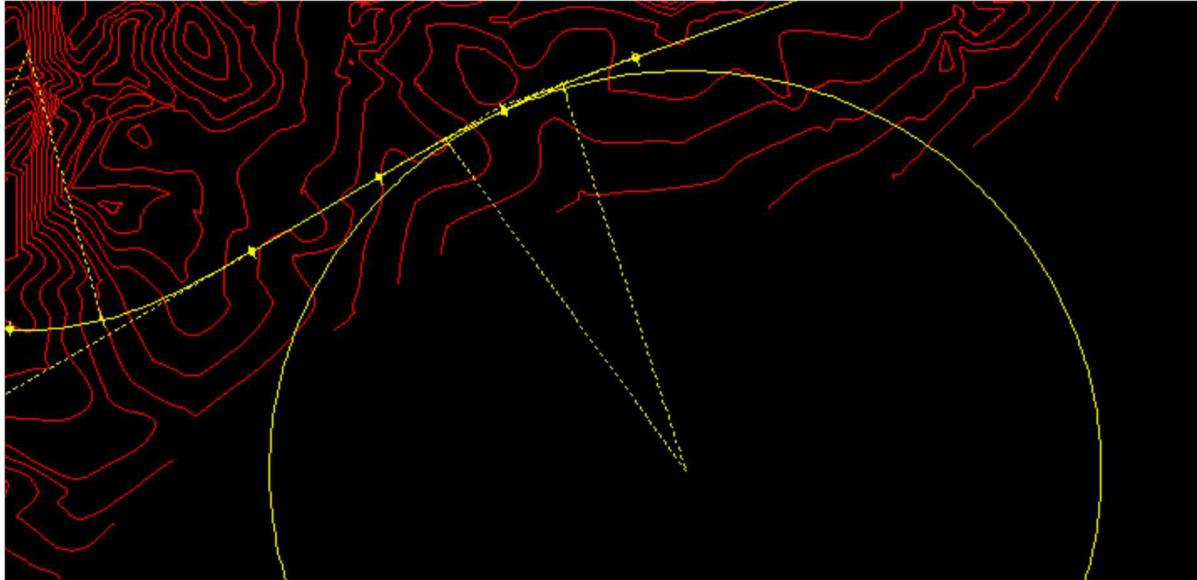
questo sta a significare che tale curva non è inseribile in quanto non vi è una deviazione sufficiente. In tali casi risulta necessario effettuare delle modifiche come, ad esempio, andare ad agire sul raggio, oppure modificare la posizione del vertice per poter risolvere la problematica. Lo spostamento del vertice avviene attraverso il comando "Sposta Vertice".
