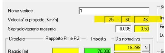
In uscita dalla prima curva la decelerazione aumenta, in quanto la seconda curva da normativa va affrontata ad una velocità di 31 Km/h.
