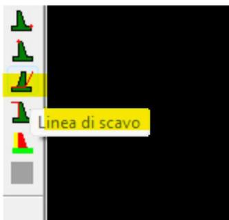
Questo comando serve per definire quanto bisogna scavare per gettare il muro e allo stesso modo vale anche per il rilevato con il comando sottostante, "Linea di rilevato".
