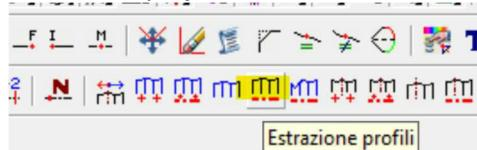
Con questo comando si esporta il profilo che risulterà rettilineo da sezione a sezione.
