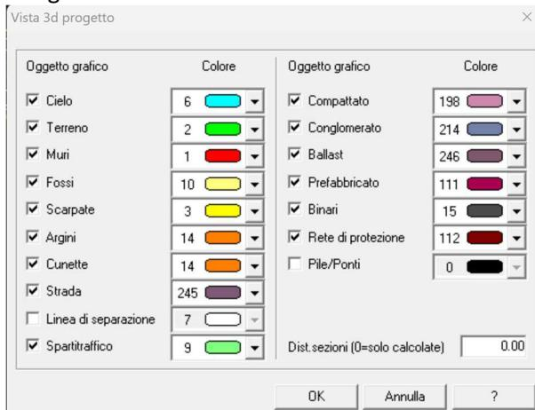
Si può indicare una “distanza sezioni” per avere una visione più fluida nelle curve. Una volta dato un nome al video possiamo inserire i dati per creare una percorrenza personalizzata.
